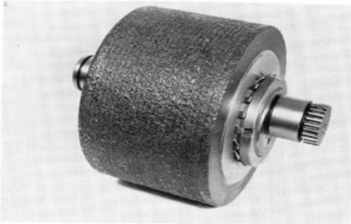
Figure 10-8. Tungsten carbide roll shell.
